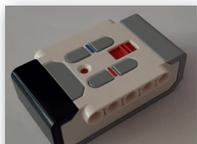
**Távirányító infravörös irányjeladó:** Segítségével távirányítható robotot építhetünk, illetve ahogy már említettük, jeladóként is működik.
