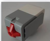
**Ütközésérzékelő:** Azt érzékeli, hogy a rajta elhelyezett piros nyomógomb benyomott vagy kiengedett állapotban van-e. Benyomott állapotban 1-es értéket, kiengedett állapotban 0 értéket ad vissza. 2-es értéket akkor ad vissza, ha a lenyomás után nem sokkal fel lett engedve a gomb.
